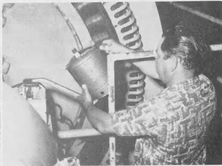
J. RASMIJN, controlman na Compressed Air Plant, ta opera y mantene e compresornan cu ta comprimi 12,500 pia cubico di aire pa minuut.
